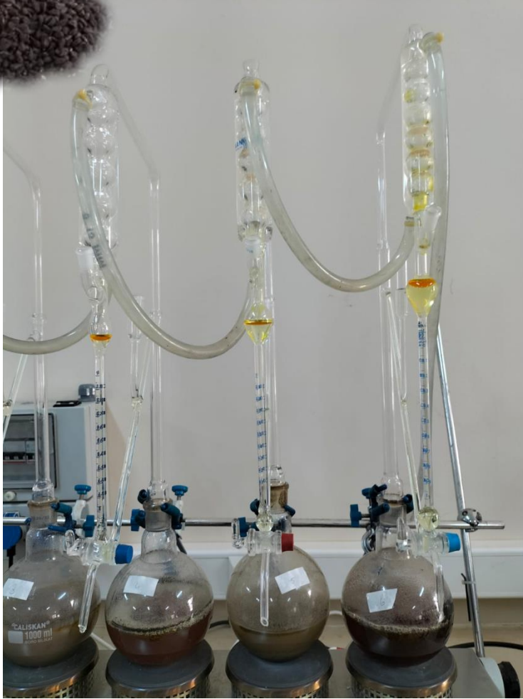
Resim 14. Çörekotu tohumlarında uçucu yağ analizi
