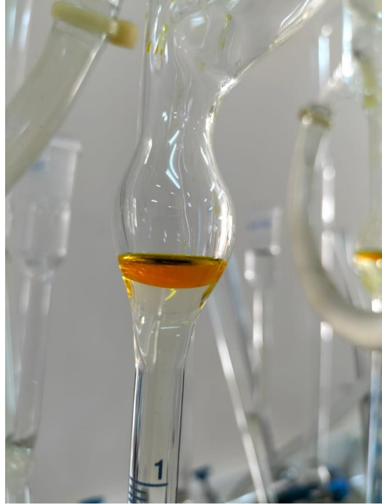
Resim 14. Çörekotu tohumlarında uçucu yağ analizi
